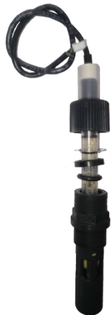
Figura 45 - Sonda e camera di analisi
